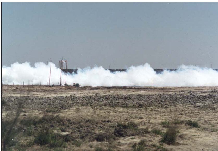
I Essai de dispersion d'ammoniaque à grande échelle réalisé par l'Ineris pour la validation des données de simulation 3D.
